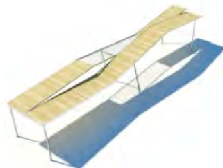
TETTOIA tavole pannelli in legno su supporto metallico
